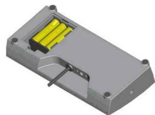
⇒ Insérer le support de piles avec les piles insérées dans l'appareil d'affichage
